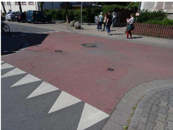
Abbildung 3: Fahrbahnmarkierung als Querungshilfe
